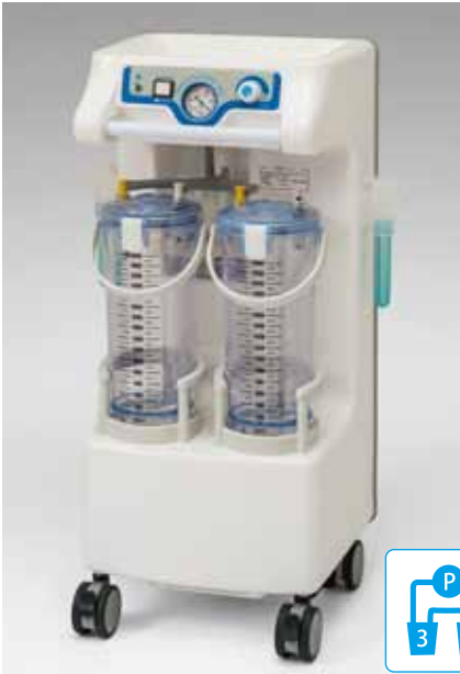
TAF-S2 (ベースモデル：TAF-S) 認証番号：230AHBZX00008000 ￥250,000 ■TAF-S にもう 1 本 3L 瓶を連結し、トータル 6L の吸引量を確保したモデルです。
